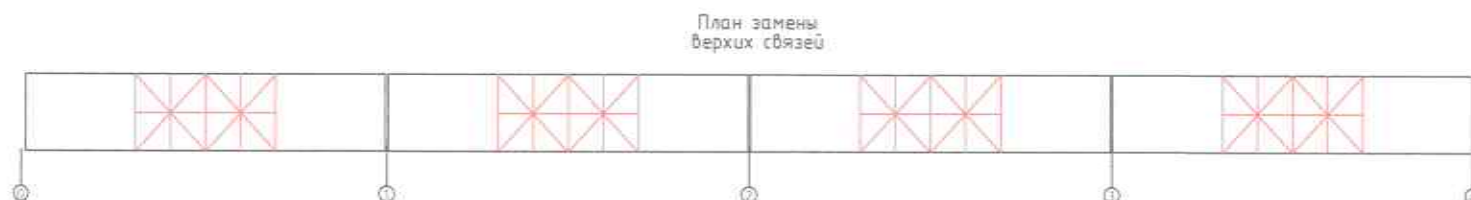
Замена поперечных и продольных верхних связей КР 1978 (См. с. 114; См. с. 130 том 3; См. с. 138 том 3)
