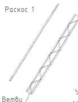
Ремонт раскосов с полной или частичной заменой ветвей КР 1978г. (См. с. 130 том 3; См. с. 133 том 3)
