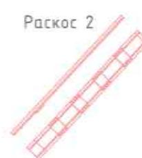
Ремонт раскосов с полной или частичной заменой ветвей КР 1978г. (См. с. 130 том 3; См. с. 133 том 3)
